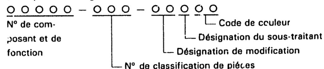
(Exemple) Boulons, écrous et autres pièces standards
