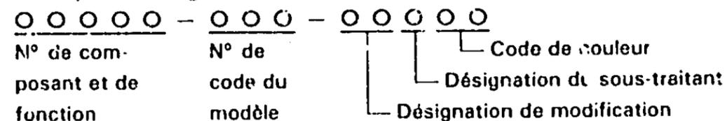
(Exemple) Boulons, écrous et autres pièces standards
